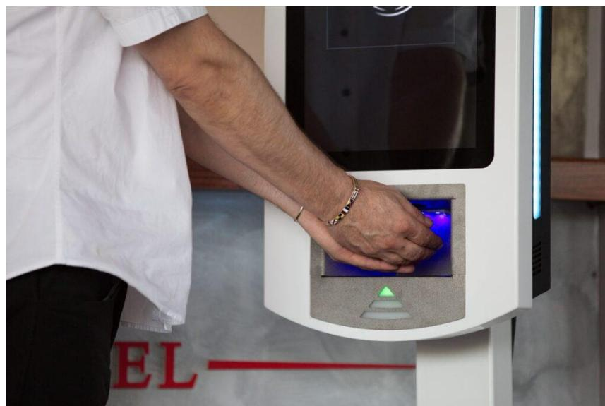
Beskontaktno doziranje / ugrađeni senzor pokreće dozator i nema fizičkog dodira niti sa jednim dijelom uređaja što maksimizira zaštitu od prijenosa virusa kontaktom
