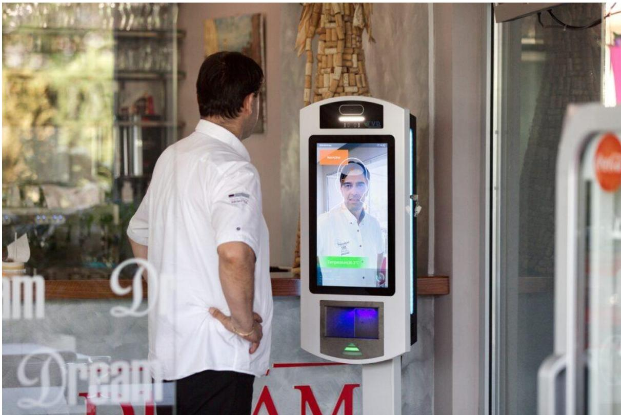
Dozator za automatsku beskontaktnu dezinfekciju ruku ima kapacitet spremnika od 4l i može se napuniti sa bilo kojom vrstom dezinfekcijskog sredstava (tekućina, gel, pjena).
